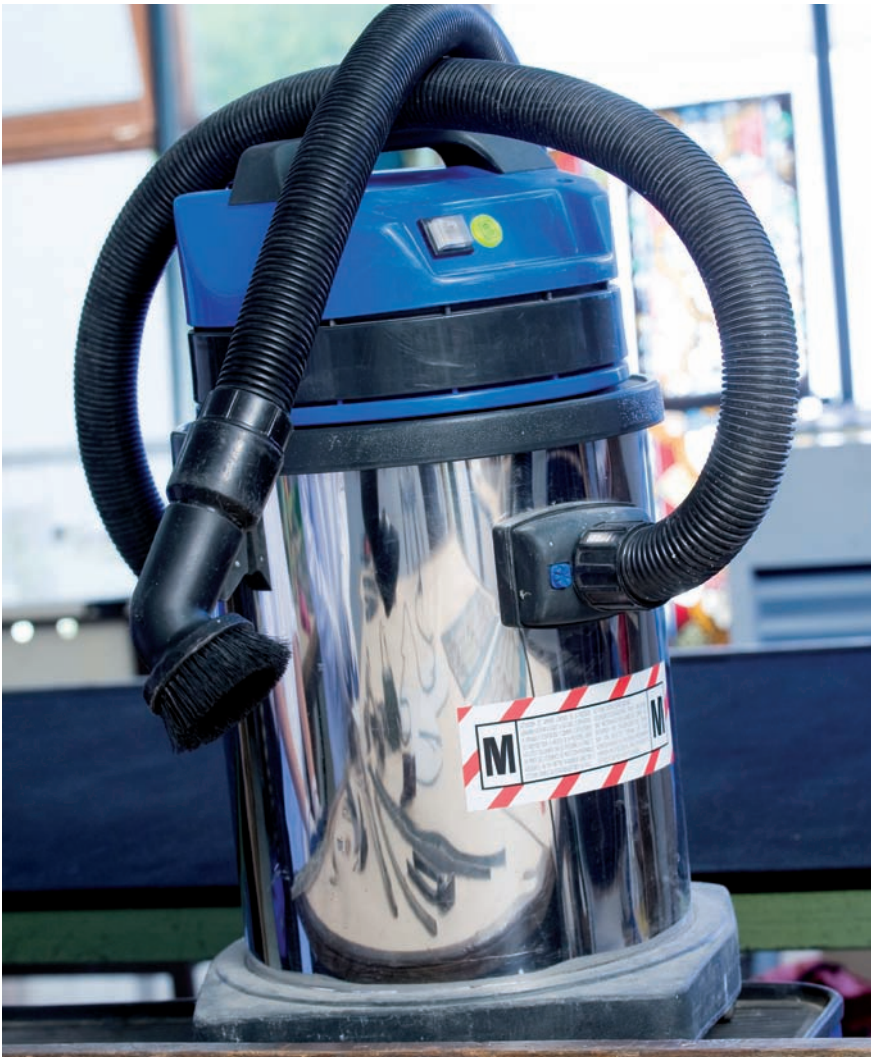
Abbildung 2: Staubsauger für bleihaltige Stäube (mindestens Kategorie „M“)
