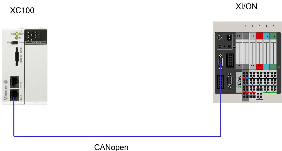
Abbildung 1 : XC 100 Steuerung verbunden mit einer XI/ON Station über den Feldbus CANopen.
