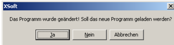
Abbildung 16 : Abfrage, ob das Programm in die Steuerung geladen werden soll, nachdem das Programm fehlerfrei übersetzt wurde.
