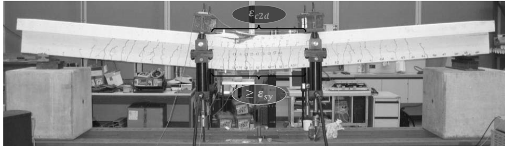
Angestrebte Bruchart (duktil): Betonbruch während Stahlfließens:
