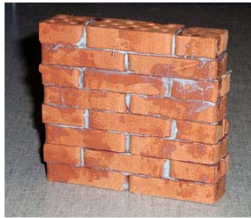
Abb. 3-2 Versuchskörper Druckversuch f_x
