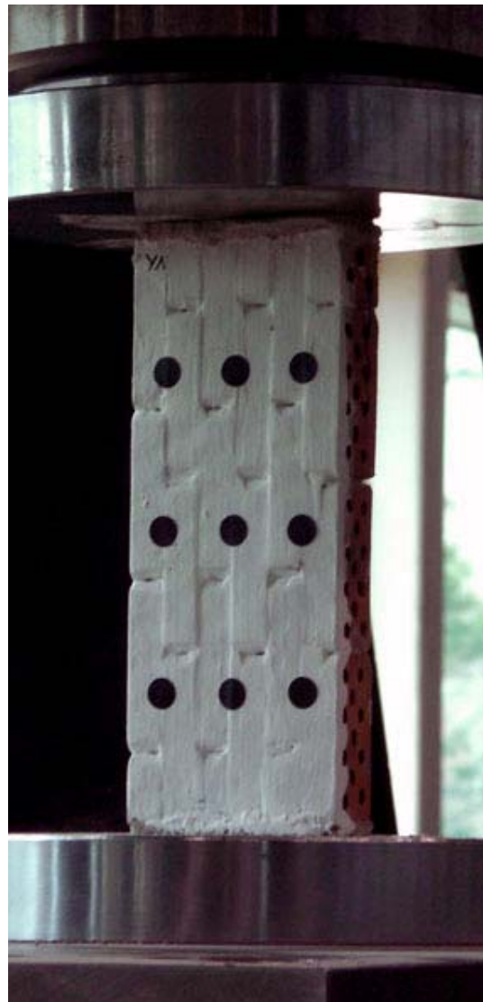
Abb. 3-9 Versuchsanordnung Druckversuch f_y
