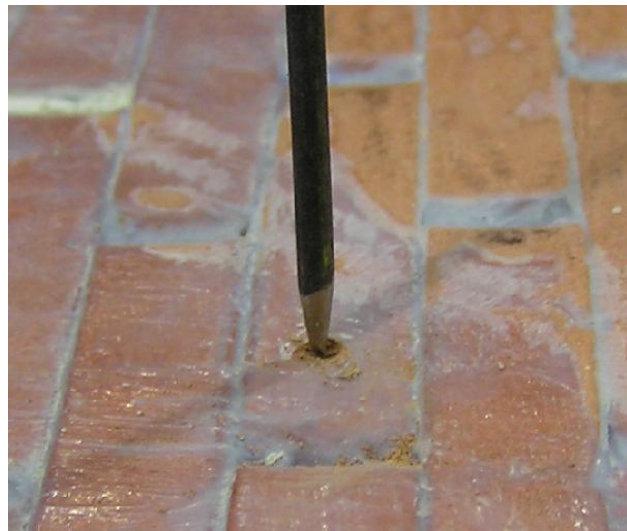
Abb. 5-13 Gesicherte Spitze der Wegaufnehmer
