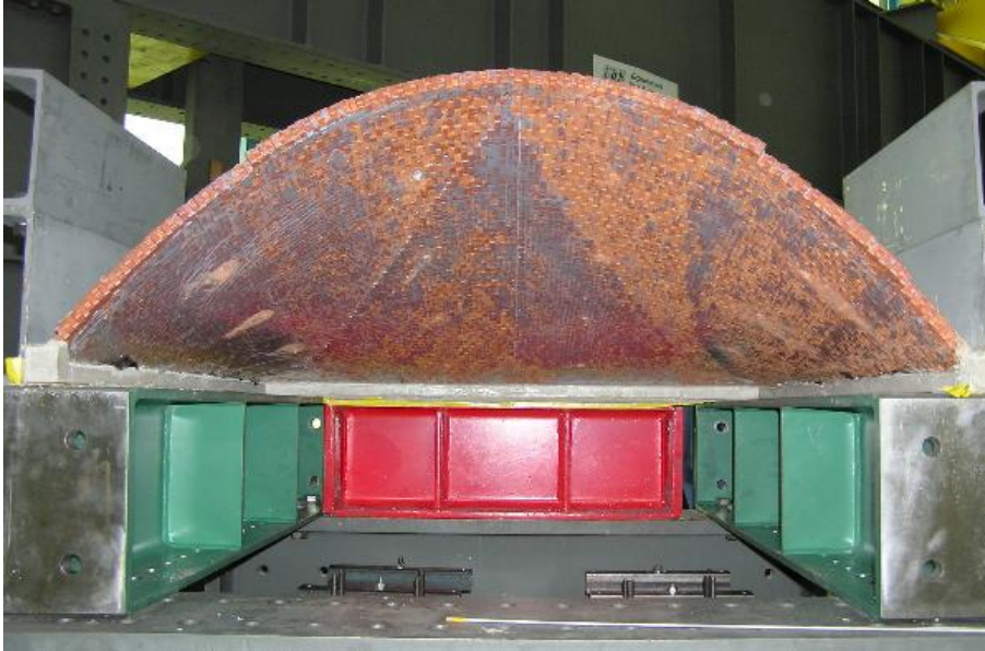
Abb. 5-7 Fertige Schale im Versuchsstand
