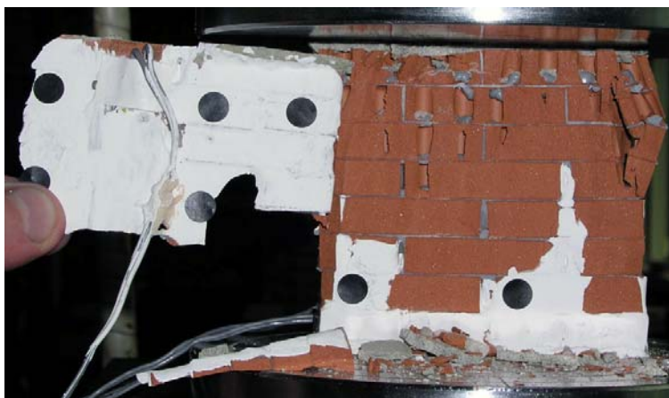
Abb. 3-30 Bruchkörper Kontrollversuch K1
