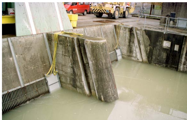
Abb. 6.3: Verlegung für Lastfall 2 bei Rechenfeld 1 und 2. Beide Rechenfelder sind jeweils rechts vertikal mit je 12.5% verlegt.
