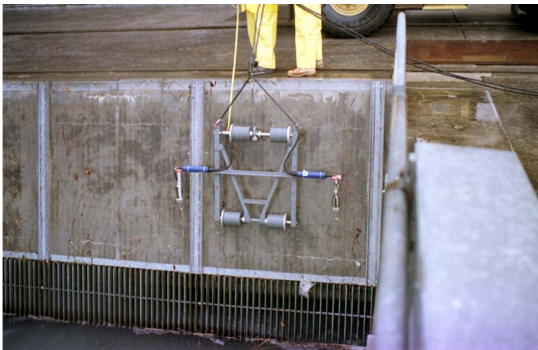
Abb. C.4: Messwagen mit den 2 montierten ADV-Sonden kurz vor dem Eintauchen in das Wasser (Lastfall1, Rechen 1).
