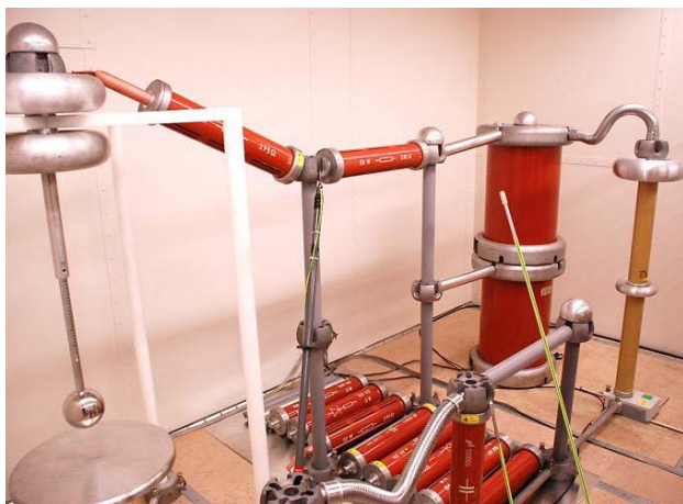
200-kV-Wechselspannungsprüfkreis im Praktikum (mit Strombegrenzungswiderstand 2 x 375 Ω)
