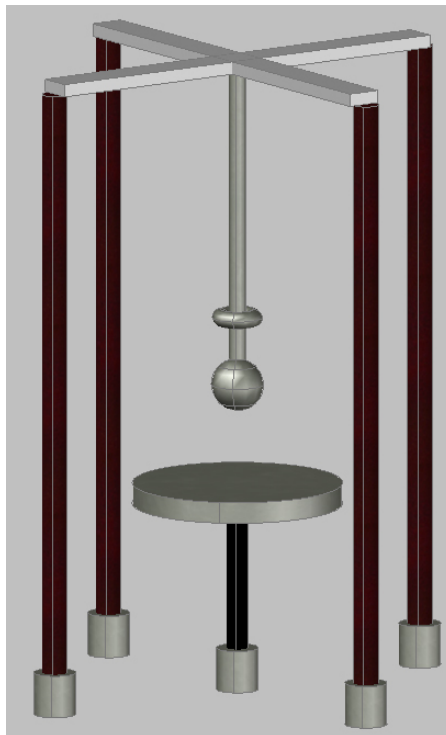
Abbildung 3: Schematische Darstellung der Versuchsanordnung (Kugel-Platte).
