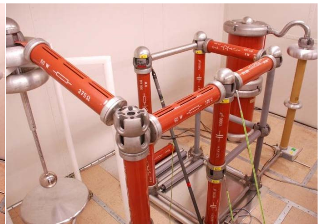
200-kV-Gleichspannungsprüfkreis im Praktikum (mit Strombegrenzungswiderstand 2 x 375 Ω)
