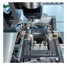
Spezifisches 4-fach Laser Knife Modul mit geregelter Einzellaseroptik
