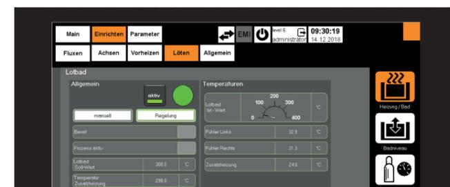
EMI EUTECT Machine Interface: Visualisierung/Überwachung aller Modulparameter & Werte
