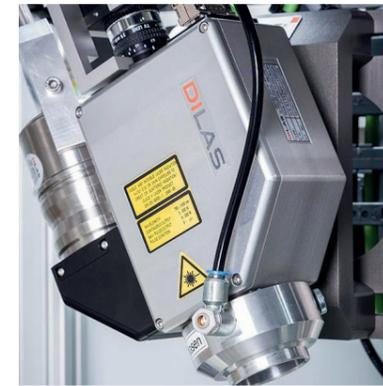
Diodenlaseroptik mit koaxial integriertem Pyrometer, Kamerasystem und Airknife
