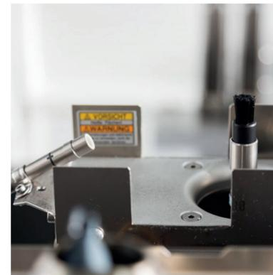
Bürstenmodul mit Ionisierungsgerät
