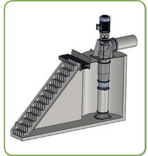
Pumpe und Rost werden von einem Dieselmotor und einem Hydrauliksystem angetrieben.
