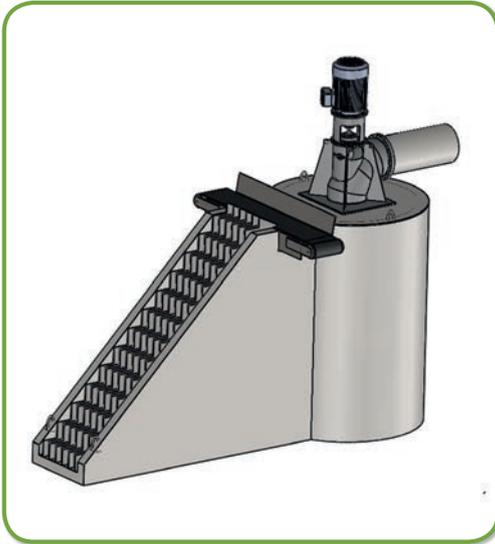
Pumpe und Rost werden von einem normalen, genormten Motor angetrieben.
