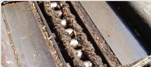
Regelmässig und weniger bringt mehr als selten und zu viel schmieren. Zwischen Bolzen, Buchsen und Rollen (Kettengelenke) muss immer eine ausreichende Menge an Schmierstoff vorhanden sein, um den Verschleiss zu mindern, vor Korrosion zu schützen und die Betriebsgeräusche zu reduzieren.
