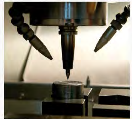
Herstellung eines Druckstempels mit einer Hochgeschwindigkeitsfräsmaschine
