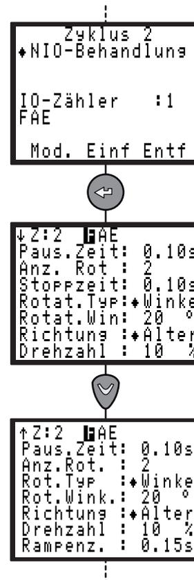
Die Maximalzeit wird bei der Fädelstufe nur angezeigt, da sie automatisch mit der Anzahl Rotationen multipliziert mit Rotationszeit + Stopzeit übereinstimmt.
