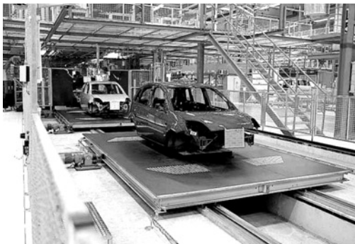
Bild 3.8: Schubplattformen (Stetigförderer – mechanisiert/automatisiert – ortsfest, aufgeständert/flurgebunden – Zugmittel) [Werkfotos: Eisenmann Maschinenbau KG]
