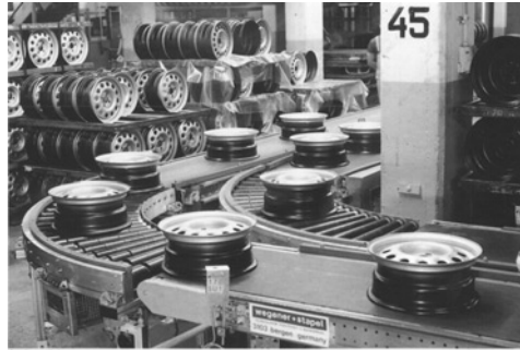
Bild 3.10: Bandförderer (Stetigförderer – mechanisiert/automatisiert – ortsfest, aufgeständert – Zugmittel); links: Aufbau und Funktion (nach [Jüne89]); rechts: Einsatz zum Fördern von Stahlfelgen [Werkfoto: Wegener + Stapel GmbH]
