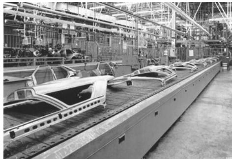
Bild 3.11: Gliederbandförderer (links, nach [Jüne89]); Plattenbandförderer (rechts [Werkfoto: Mannesmann Dematic GmbH]) (Stetigförderer – mechanisiert/automatisiert – ortsfest, aufgeständert – Zugmittel)
