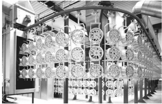
Bild 3.15: Kreisförderer, links: Prinzip (nach [Jüne89]), rechts: Einsatz in einer Lackieranlage für Leichtmetallfelgen [Werkfoto: AFT GmbH & Co KG] (Stetigförderer – mechanisiert/automatisiert – ortsfest, flurfrei – Zugmittel)
