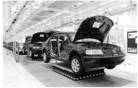
Bild 3.7: Skid-Rollenbahn in einer Lackieranlage (links) [Werkfoto: Eisenmann Maschinenbau KG]; Schubskidförderer in einer Endmontagelinie (rechts) [Werkfoto: AFT GmbH & Co KG] (Stetigförderer – mechanisiert/automatisiert – ortsfest, aufgeständert/flurgebunden – Zugmittel)
