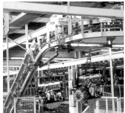
Bild 3.16: Schleppkreisförderer, links: Prinzip [Werkbild: Eisenmann Maschinenbau KG], rechts: Einsatz zum Motortransport [Werkfoto: ThyssenKrupp Stahlbau GmbH] (Stetigförderer – mechanisiert/automatisiert – ortsfest, flurfrei – Zugmittel)
