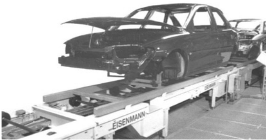
Bild 3.7: Skid-Rollenbahn in einer Lackieranlage (links) [Werkfoto: Eisenmann Maschinenbau KG]; Schubskidförderer in einer Endmontagelinie (rechts) [Werkfoto: AFT GmbH & Co KG] (Stetigförderer – mechanisiert/automatisiert – ortsfest, aufgeständert/flurgebunden – Zugmittel)
