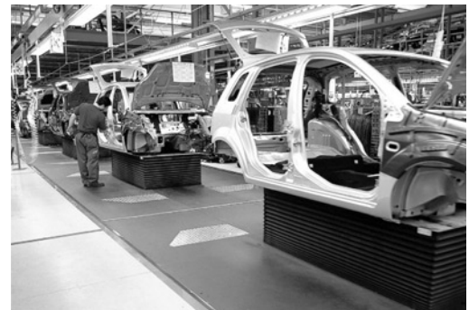
Bild 3.8: Schubplattformen (Stetigförderer – mechanisiert/automatisiert – ortsfest, aufgeständert/flurgebunden – Zugmittel) [Werkfotos: Eisenmann Maschinenbau KG]
