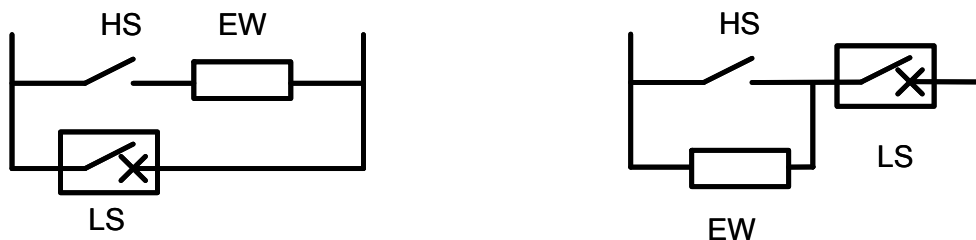
Bild 3 Prinzipschaltbild eines Leistungsschalters (LS) mit Einschaltwiderstand (EW) und Hilfsschalter (HS) Links: Einschaltwiderstand parallel zum Leistungsschalter Rechts: Einschaltwiderstand in Reihe zum Leistungsschalter
