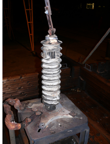
POLIM-Ableiter nach Prüfung mit 50kA-0.2s
