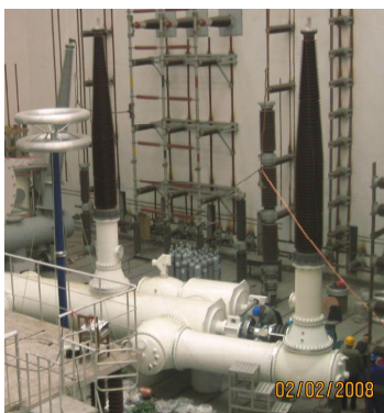
Bild 15 1100-kV-Leistungsschalter im Leistungsversuchfeld XIHARI Links: Versuchsaufbau Rechts: geforderter und prospektiver TRV - Verlauf beim Klemmenkurzschluss T100s
