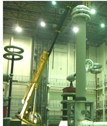
Bild 10 Logistik beim Transport und Aufbau der Versuchgeräte Links: Leistungsschalter im Schnee Rechts: Durchführungsmontage im Hochspannungslabor XIHARI
