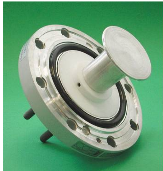
Bild 11 Hochspannungs-Typentest im Hochspannungslabor XIHARI Links: Versuchsaufbau Rechts: UHF-Teilentladungssensor
