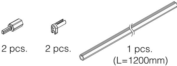
Wir empfehlen eine Synchronisationsstange für Schubladen mit Fronten von über 600mm Breite.
