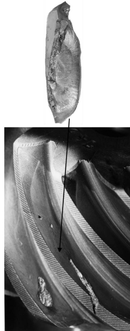
Zahnflankenbruch an einem Kegelritzel und der entsprechende Ausbruch
