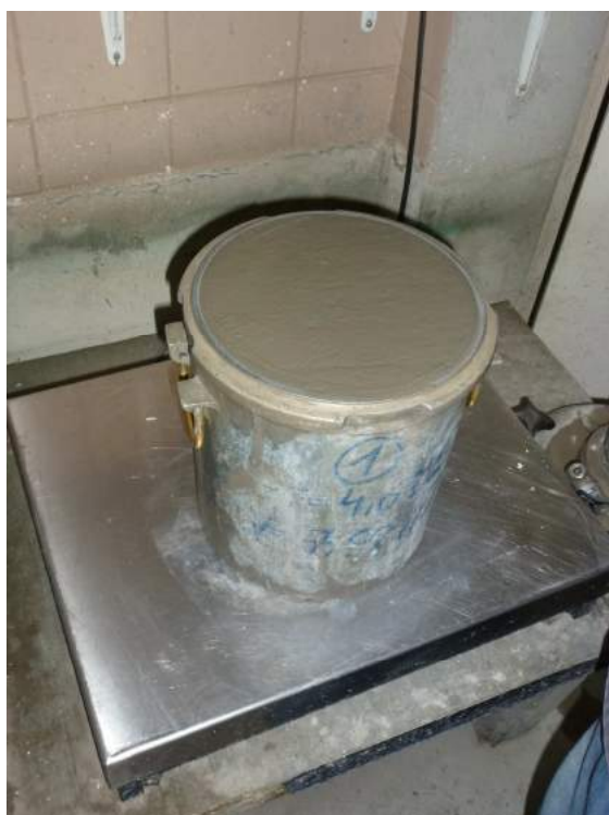
Abbildung 13: Bestimmung der Rohdichte am Frischbeton
