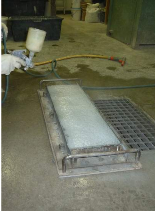
Abbildung 16: Aufbringen des Kombinationsmittels direkt nach der Herstellung
