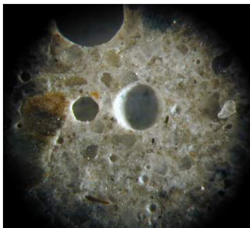
Abbildung 18: Geschliffener Straßenoberbeton unter dem Mikroskop
