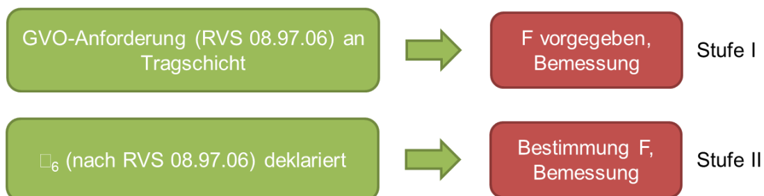
Abbildung 43: Bemessungsstufen zur Ermittlung der Materialermüdung
