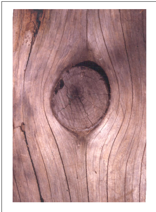
Abbildung 3.7: Spindelförmiger Faserverlauf um einen morschen Ast.
