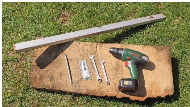
Für die Montage wird ein **Akkuschrauber** mit einem **4,2 mm Metallbohrer** sowie ein **Kreuzschlitzschraubendreher** (PH2) benötigt.
