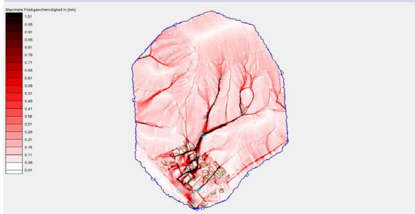
Abbildung 3: Maximale Fließgeschwindigkeit im Untersuchungsgebiet (Referenzmodell)
