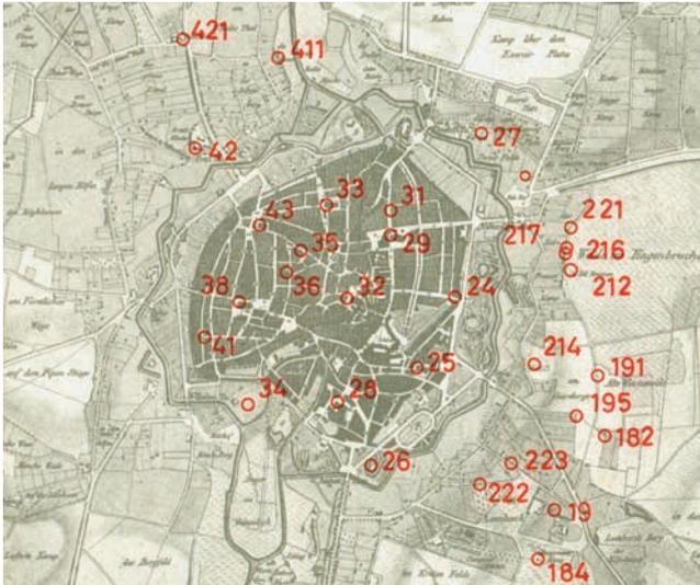
Abb. 5: Erste trigonometrische Vermessungen hat Gauß auf diesen Punkten im Stadtgebiet Braunschweigs ausgeführt.
