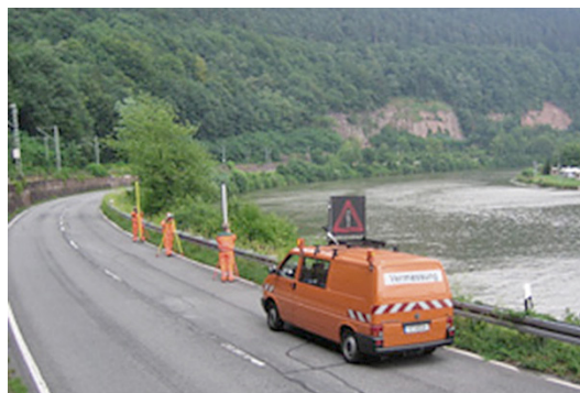
Abb. 5: Nivellementtrupp direkt vor einem Sicherungsfahrzeug
