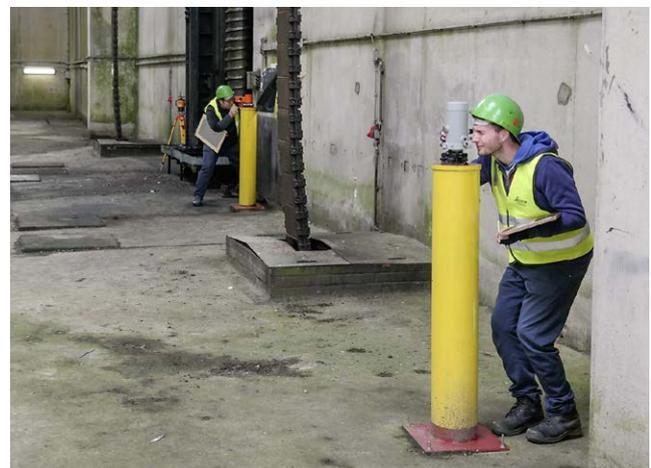
Abb. 8: Lotungsmessungen mit optischem (vorne) und Laserlot (hinten)
