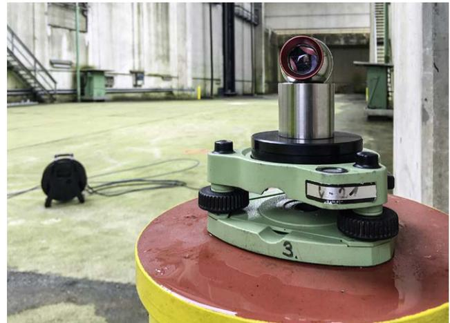
Abb. 6: CCR-Adapter zur Verknüpfung von Lasertracker- und Tachymetermessungen
