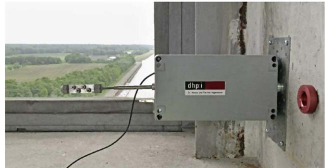
Abb. 11: Invarextensometer im nördlichen Verbindungsgang des Westtroges
