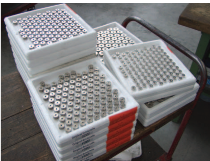
Vorspannverankerungen in Styroporschachteln
