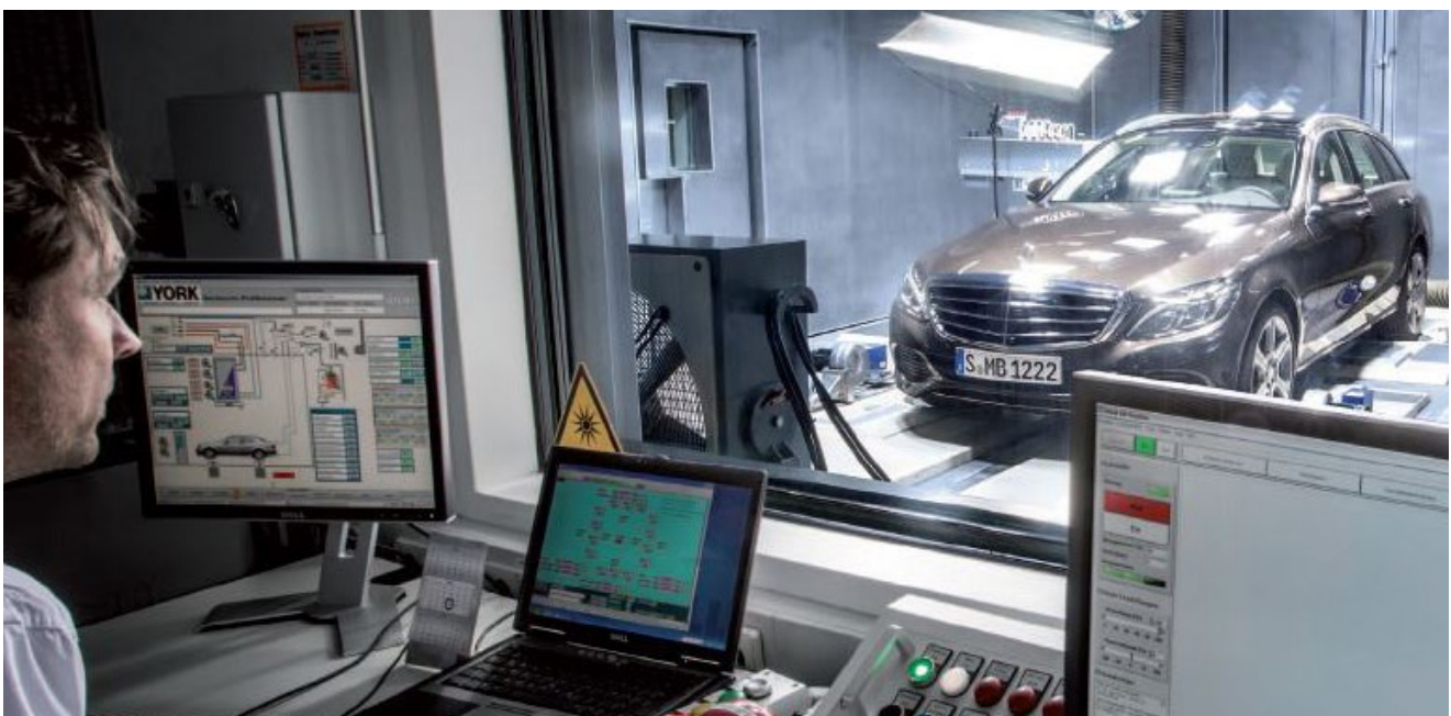
Abbildung 3-1: Prüfkammer zur Messung von Innenraumemissionen
