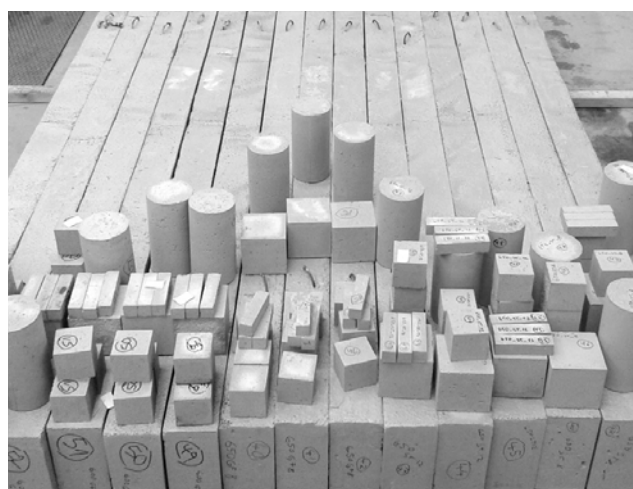
05 Typische Prüfkörper im Betonlabor
