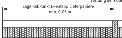
Abb. 6: Definition der Zählrichtung mit Magnetband und Montage Sensor Magnetband, Abstandsmaße, Toleranzen
