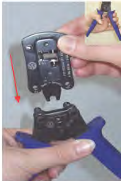
Mount the crimping insert into the crimping handles Crimpeinsatz in den Zangengriff einsetzen
