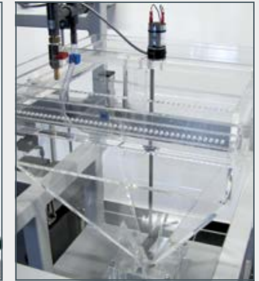
Nachklärbecken zur Abtrennung des Belebtschlammes
