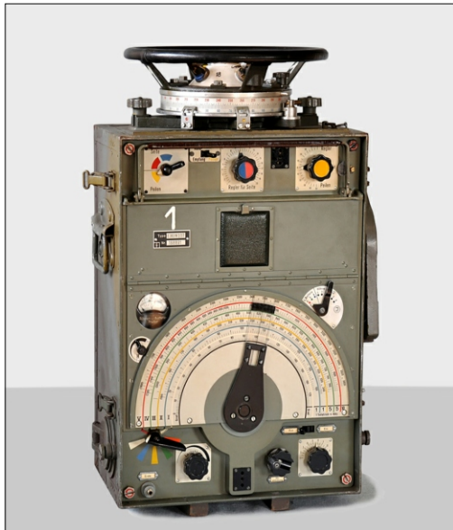
Bild 11: Peilempfänger E 383 N2 (mit später eingebautem Kippschalter für Rundempfang). Aufgesetzter Peilkopf mit Skala, Handrad und Isolator zur Befestigung des zusammenklappbaren Peilrahmens
