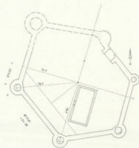
Abb. 13. Rekonstruiertes Meßnetz für die Bauabschnitte 1 und 2
