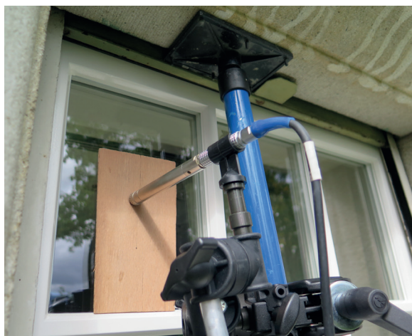
Messaufbau zur Bestimmung des Schalldämmmaßes eines Fensters: Einstellen eines Abstands von 3 mm zwischen Mikrophon und Verglasung mittels eines Abstandshalters, Quelle: Wehle, 2018, S. 17
