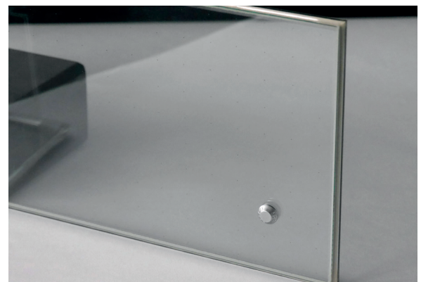
Vakuumisolierverglasung mit verlötetem Glasrandverbund und Ventil zur Evakuierung (ein europäischer Hersteller liefert Vakuumisolierverglasungen ohne das störende Evakuierungsventil), Quelle: Hochschule für Technik Stuttgart, 2019, S. 24
