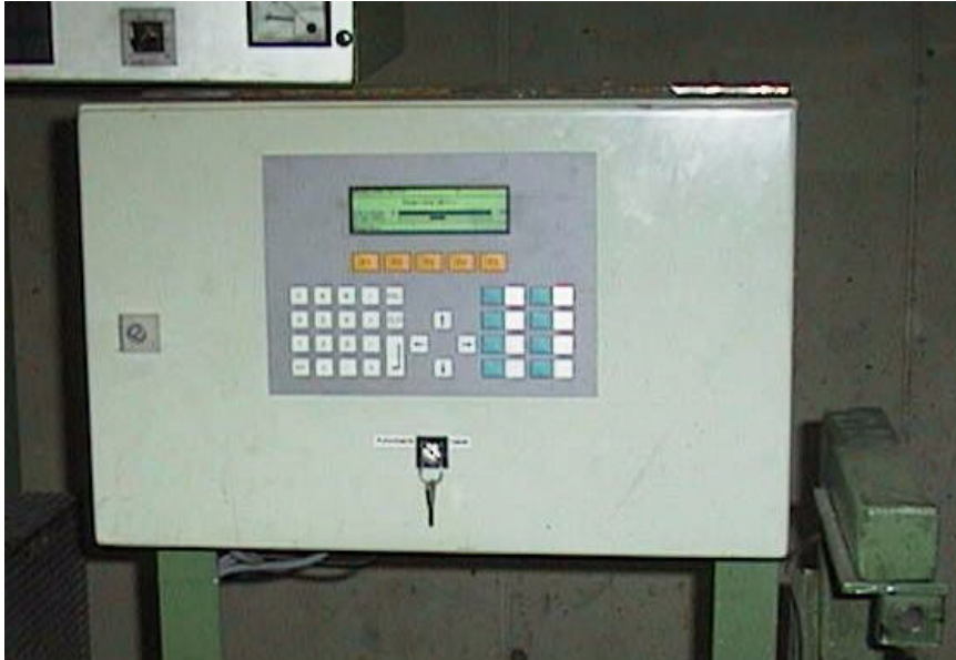
Bild 7: Regelgerät eingebaut in eine Mehrblattkreissäge
