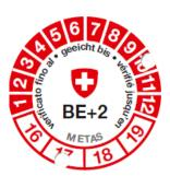
**Abbildung 14** Genügt ein Messmittel den Anforderungen, so wird die Nacheichung durch Anbringen einer Eichmarke bestätigt. <a href="www.metas.ch">www.metas.ch</a>
