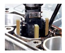
**Abbildung 1** links: Kolben im Motorblock, rechts: Oberflächenbehandlung wie Hohnen erfolgt, um den Durchmesser des Motorblocks bis auf die Rauhigkeitstiefe von 4 bis  $10\mu m$  zu optimieren.
