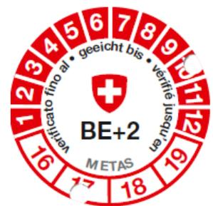
**Abbildung 14** Genügt ein Messmittel den Anforderungen, so wird die Nacheichung durch Anbringen einer Eichmarke bestätigt. [www.metas.ch](http://www.metas.ch)
