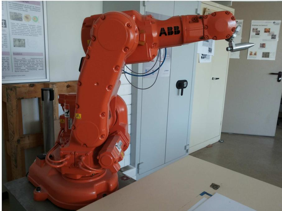
Abbildung 3.3.: Stationärer 6-achsiger Industrieroboter ABB IRB140 (Abb. KW)
