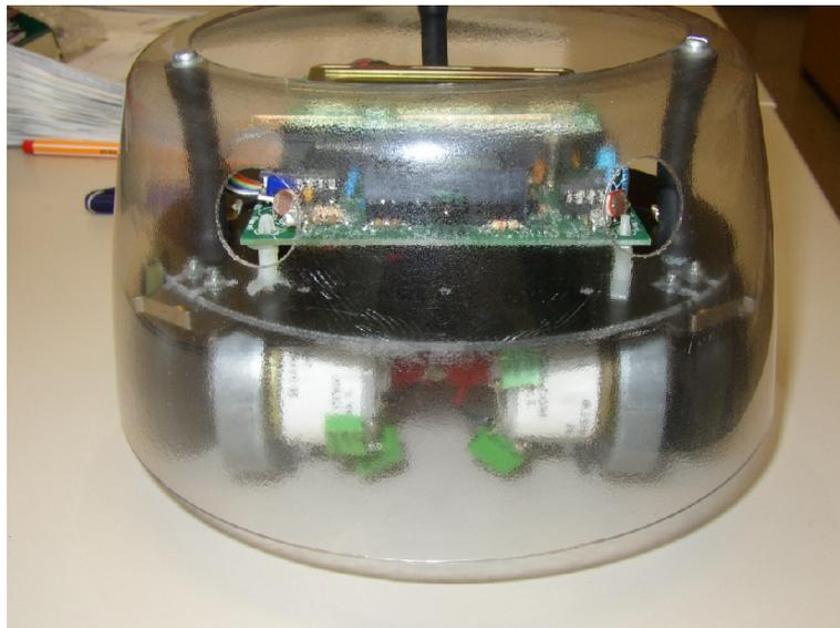
Abbildung C.1.: Rug Warrior von vorne. Rechts und links sind die Öffnungen für die IR-Sendedioden in der Plexiglasschürze zu erkennen.
