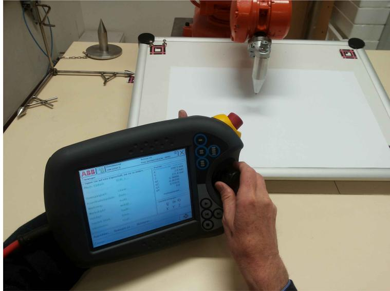
Abbildung 5.4.: Der Roboter wird behutsam mit dem Joystick bewegt.
