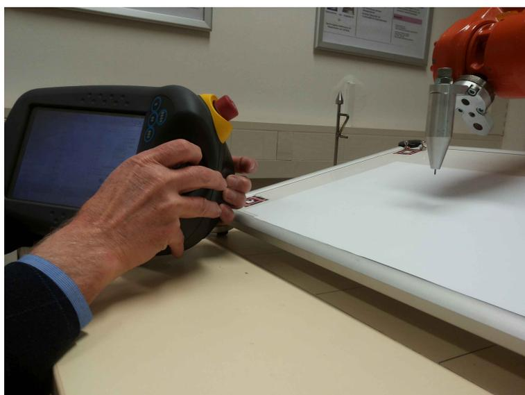
Abbildung 5.3.: Beim einteachen steht man oft nah am Roboter.
