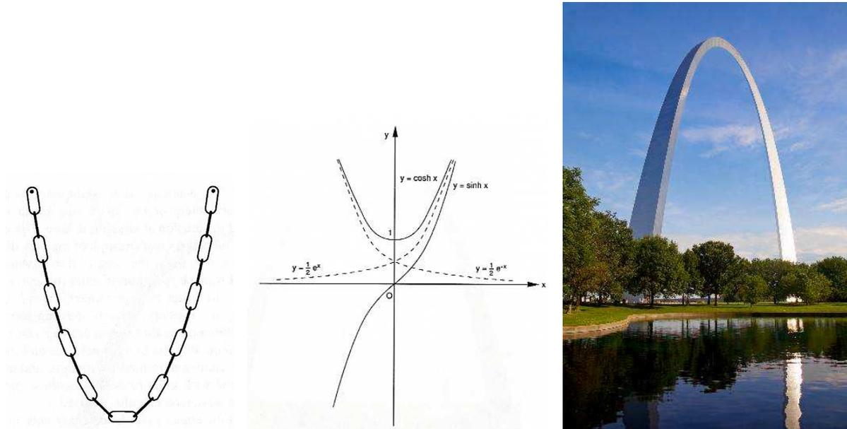
Eine Umkehrung der durchhängenden Kette können Besucher der USA in St. Louis bewundern: den Gateway Arch. Er ist 192 m hoch und wurde 1965 am Ufer des Mississippi errichtet. Aber auch Brückenbögen und alle Hängebrücken sind statisch nach dem Prinzip der Seil- oder Kettenlinie berechnet.
