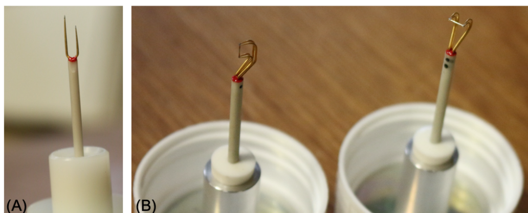
Bild 4.6: Verwendete Hitzdraht-Sondenkopf-Typen: 45Grad 1-Draht-Sonde 55R02 (A) sowie die Split-Fiber-Sonden 55R57 (B, links) und 55R56 (B, rechts)
