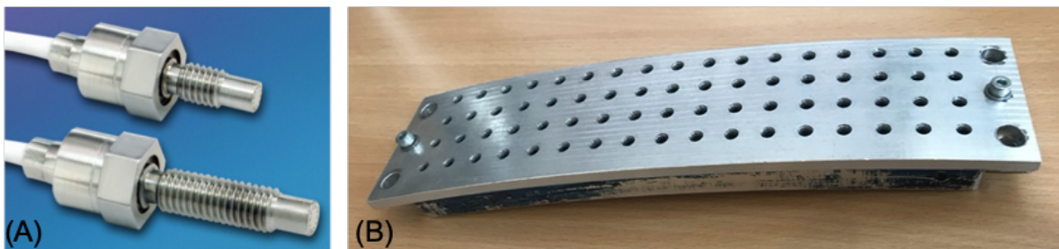
Bild 4.12: Piezoresistiver Zylinderform-Drucksensor KULITE XT-190 (Quelle: KULITE) (A), Gehäuse-Modul mit 68 Sensor-Zugängen zur zeit-aufgelösten Seitenwanddruck-Erfassung (B)
