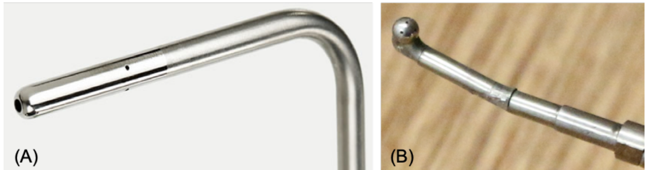
Bild 4.3: Verwendete pneumatische Strömungssonden: Prandtl-Sonde (A) und Fünflochsonde (B)
