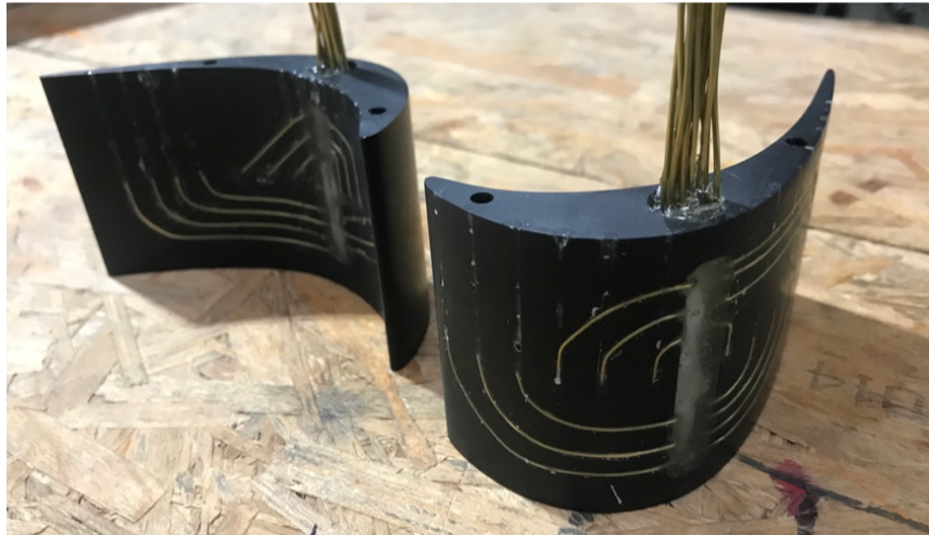
Bild 4.8: Druckmess-Schaufel-Module zur zeit-gemittelten Schaufeldruck-Erfassung zum Einbau in die modulare Messschaufel
