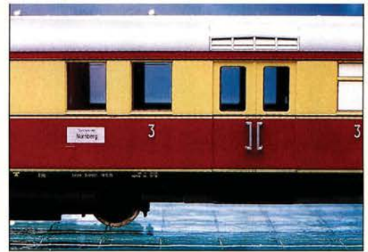
An Katos ET 25 gefällt vor allem das saubere Finish. Links der filigrane Dachstromabnehmer und die Dachleitungen, oben der Einstieg zum Großraum 3. Klasse mit den charakteristischen Schiebetüren.
