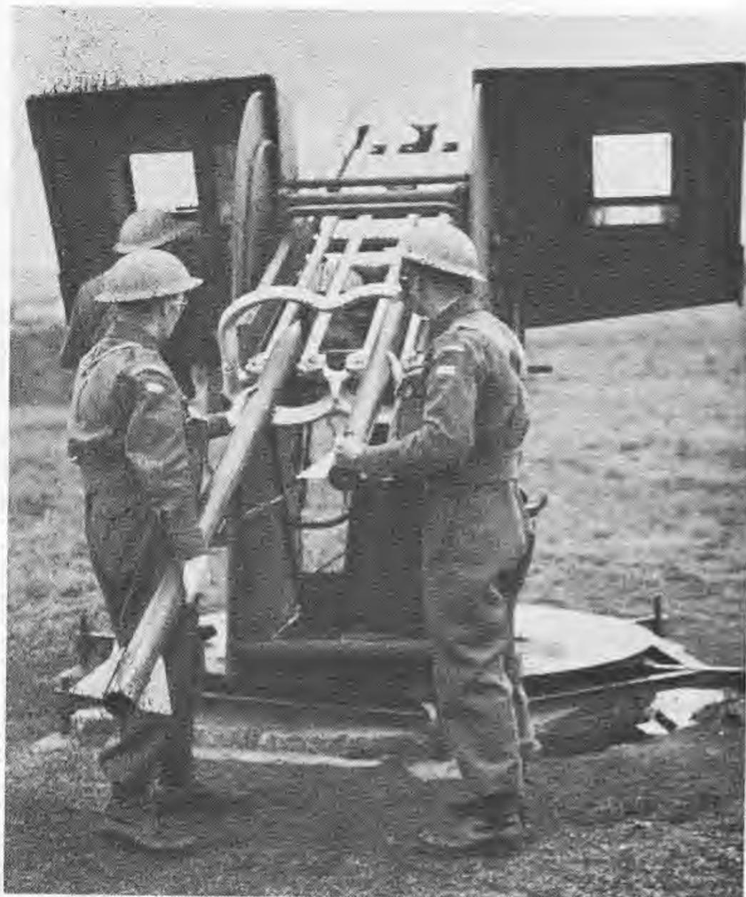
Bild 9: Die Raketen werden von hinten eingeschoben
