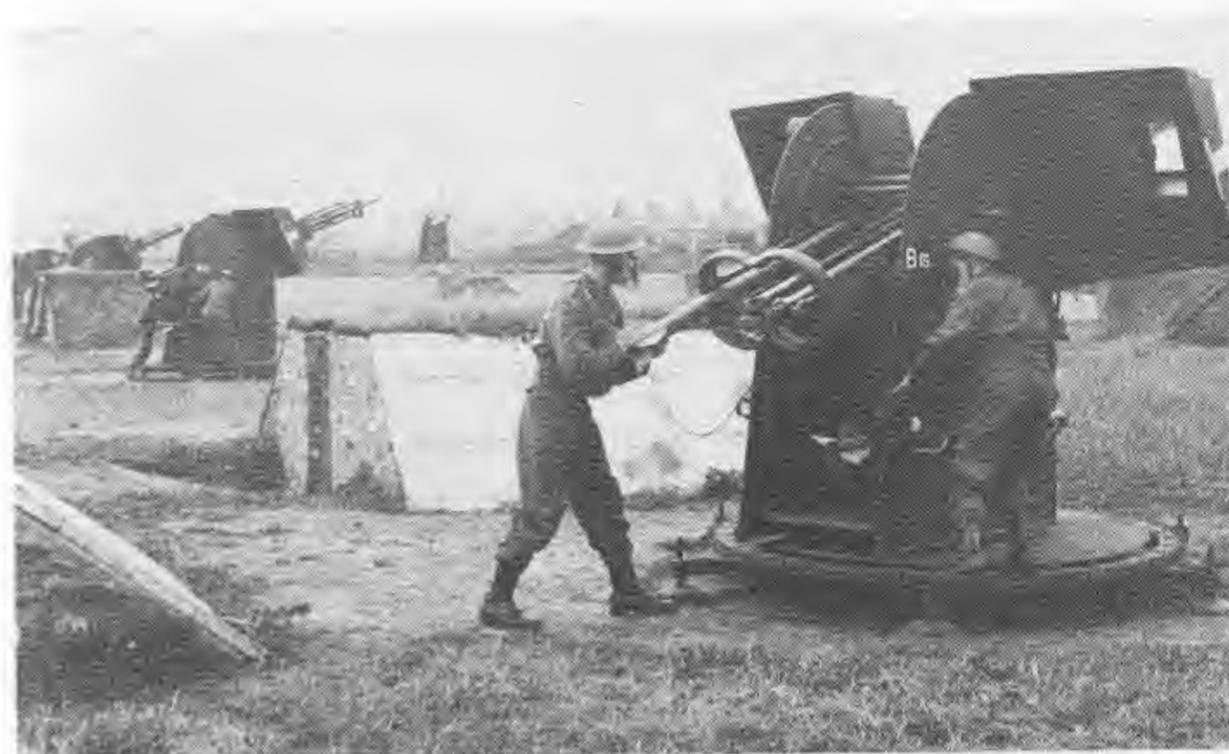
Bild 7: 3-Zoll-Projektor No. 2 Mark 1. Während die erste Rakete geladen wird ...
