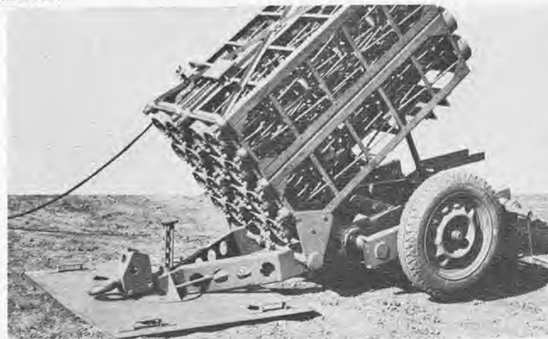
Bild 36: . . . . . die z. B. im sumpfigen oder weichen Gelände unter den Sporn gelegt
