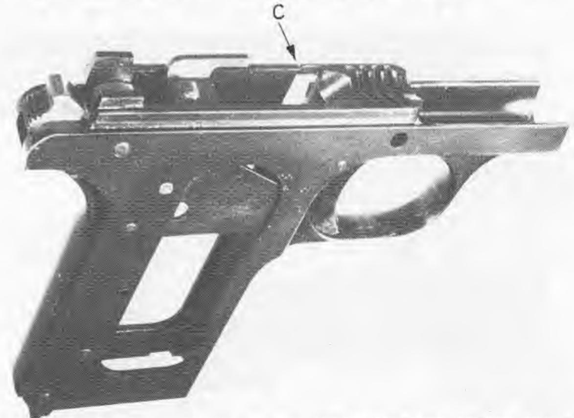
Bild 10: An der Durchgangsöffnung für den Schlittenfanghebel befindet sich ein Schlitz C, dessen Zweck unklar ist.
