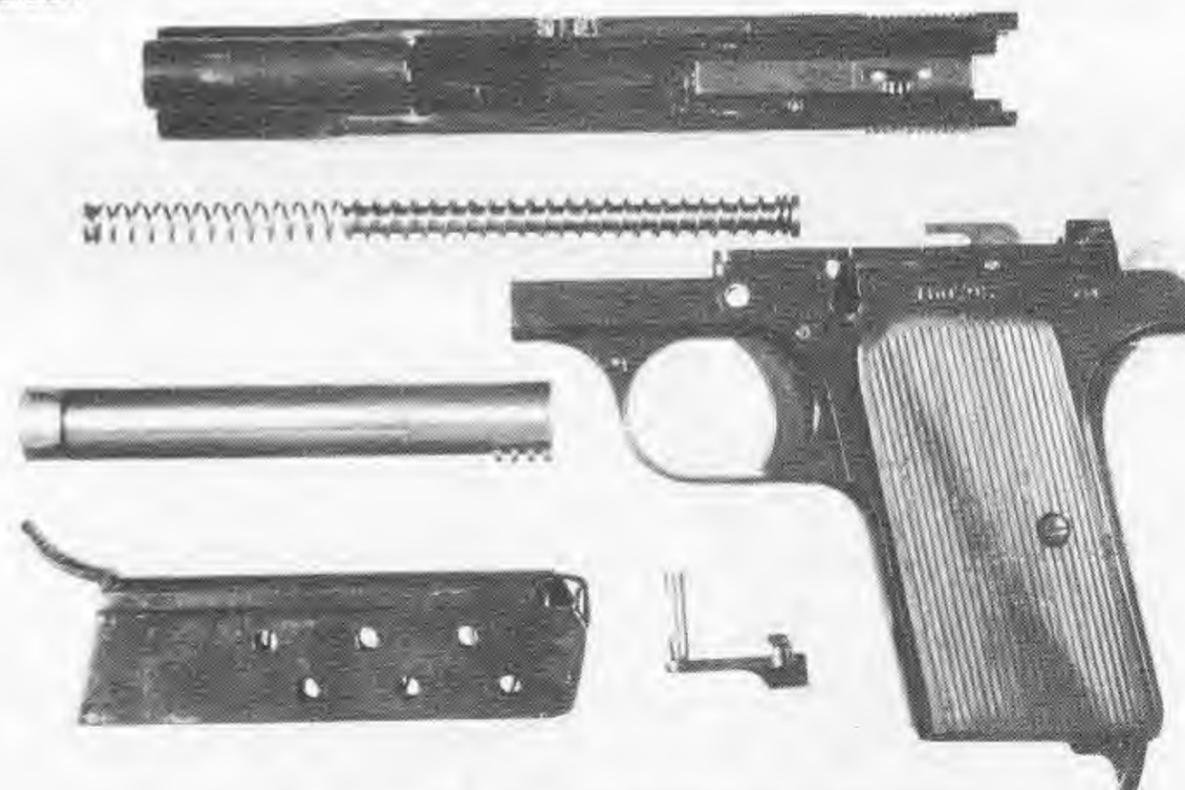
Bild 13: Pistole zur Pflege und Reinigung zerlegt.
