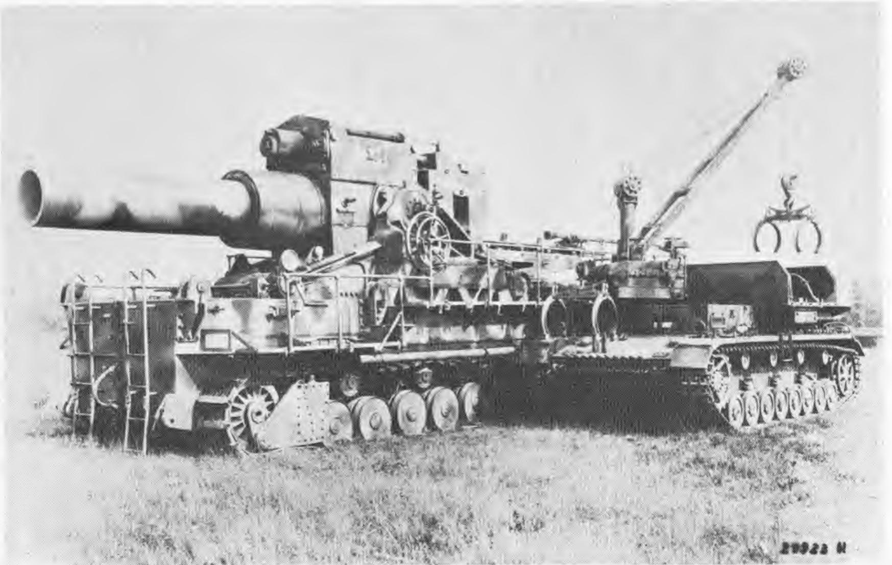
Bild 8: Der „Loki“ im Kaliber 54 cm mit Munitions-Schlepper
