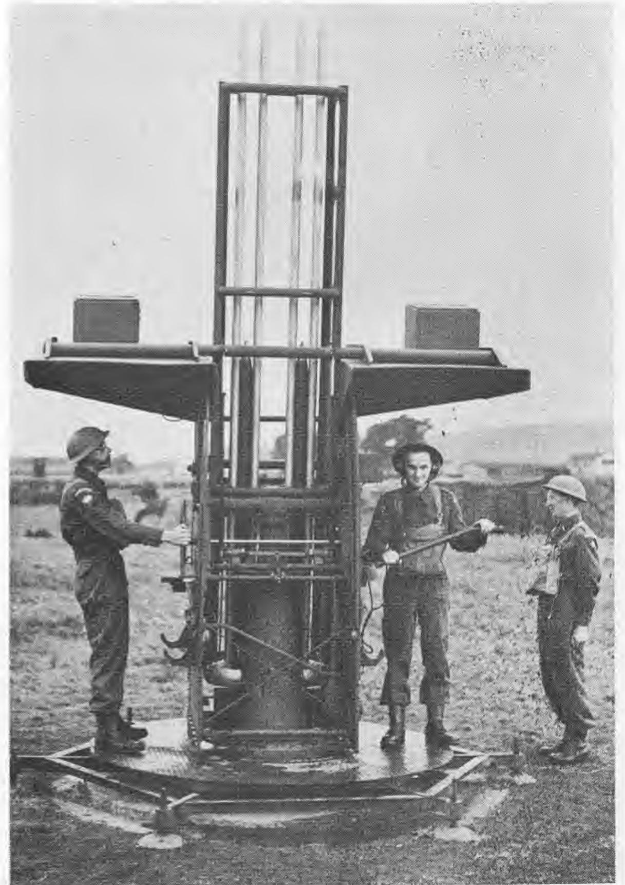
Bild 5: 3-Zoll-Projektor No. 2 Mark 1 in Feuerstellung (Bei der Ausbildung)
