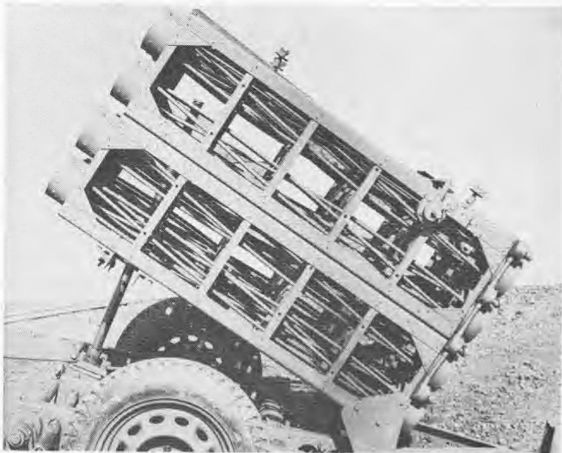
Bild 37: No. 11 Mark 1, von links. Man erkennt den Höhentrieb vorn am Gerät.
