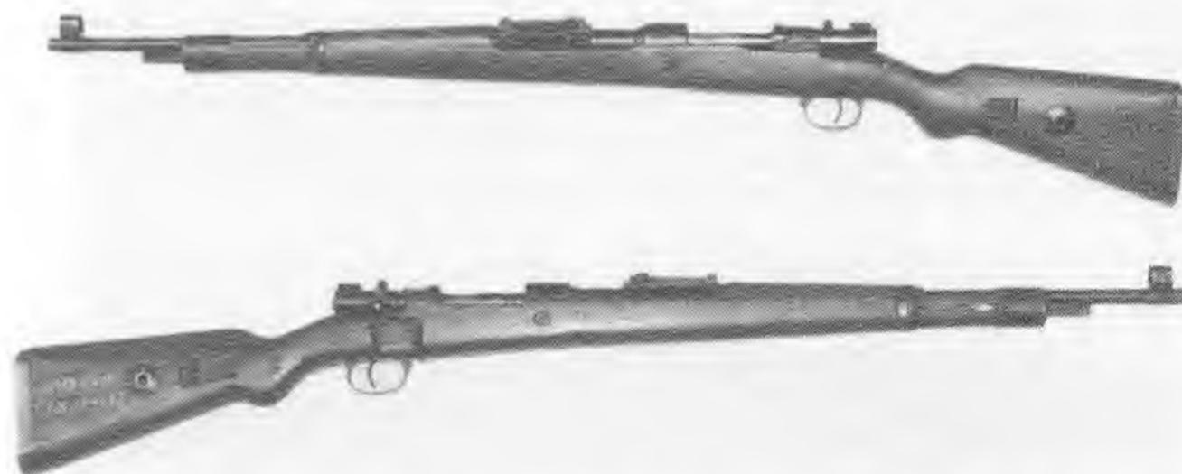
Bild 1: Karabiner 98 k (mit Schiene für Zf 42) mit eingesetztem E.L. 24, von links und rechts
