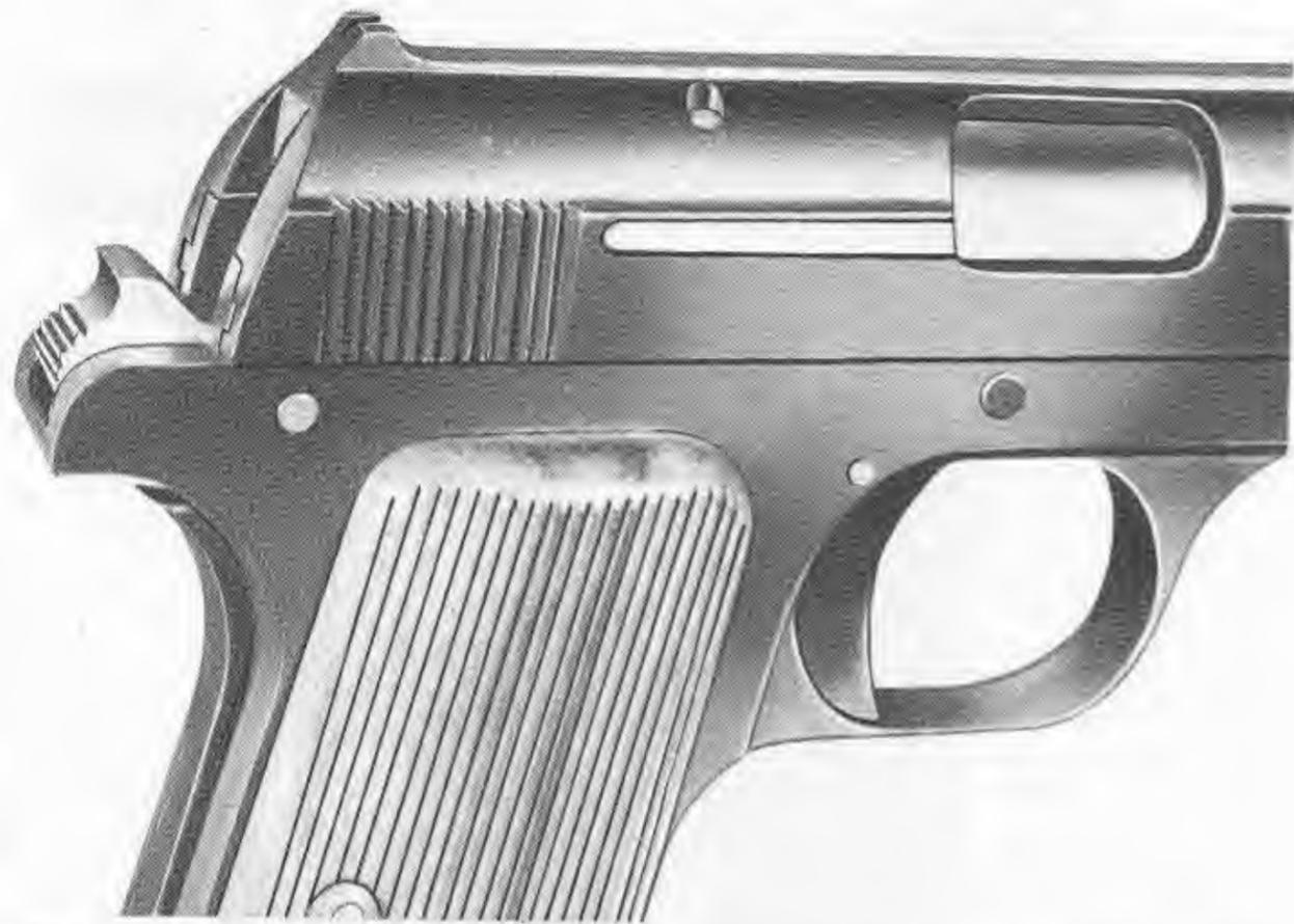
Bild 8: Der Hahn (hier im gespannten Zustand) ragt nur wenig über die Gehäuse- und Schlittenhinterkante hinaus.
