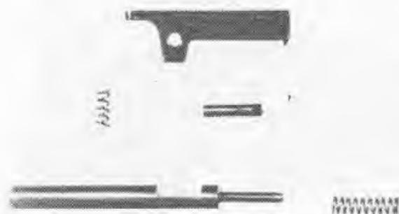
Bild 15: Schlitten mit ausgebautem Auszieher, Feder und Lagerstift sowie Schlagbolzen mit Feder.
