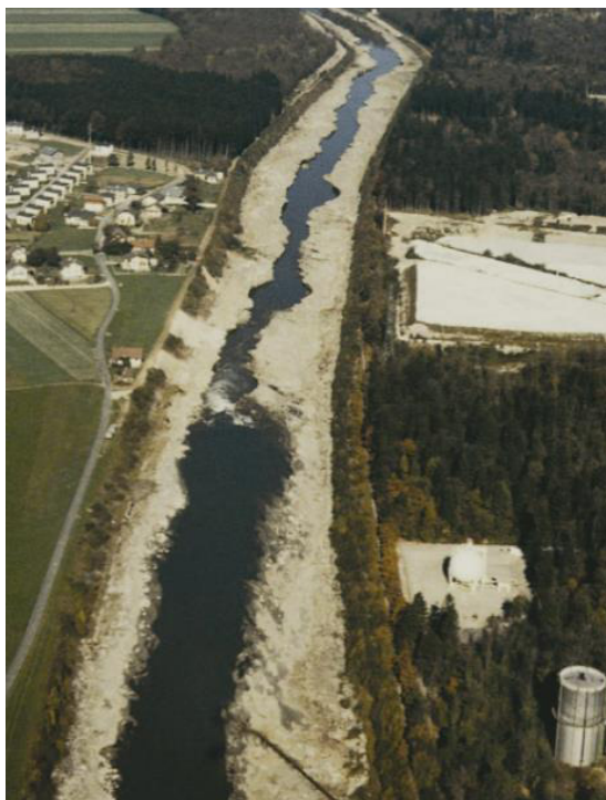
Abbildung 17: Sohldurchschlag (links) und Einsturz der Autobahnbrücke Lieferung (rechts) an der Salzach vom 13.08.1969 (WRS, 2000).
