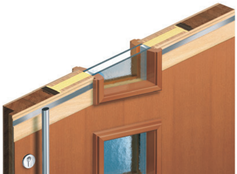
Abb. 3.6: Türkonstruktion mit Sperrholz
