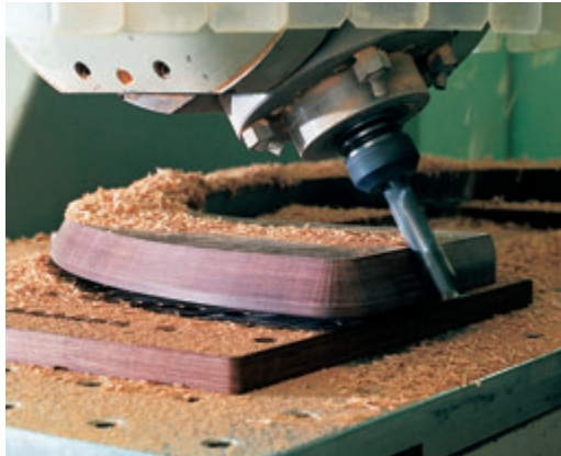
Abb. 3.18: Festholz in der Bearbeitung
