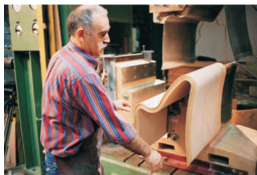
Abb. 3.8: Fertigung von Formsperrholz für den Möbelbau
