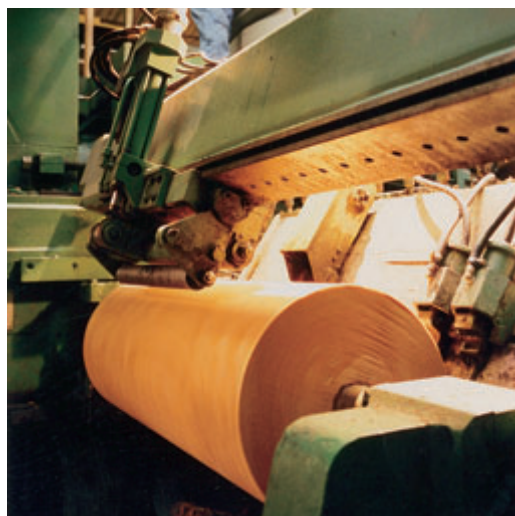
Abb. 2.9: Buchenstamm in der Schälmaschine
