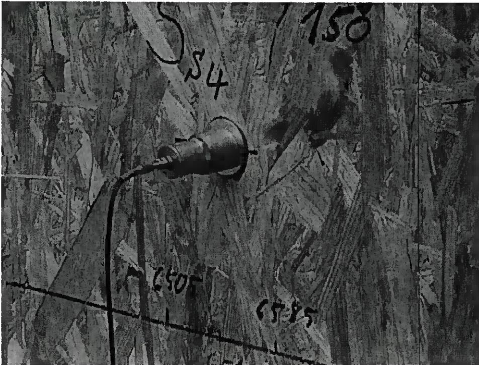
**Bild 21** Positionierung des Aufnehmers auf der Wand
