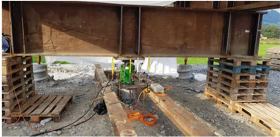
Bild 10. Versuchsaufbau für die Probelastung eines quadratischen Fundaments mit 0.5 m Einbindetiefe und 1 m 2 Grundfläche Bild: Geotechnik Schweiz, Heft 22 (1958), Beitrag von Heinz Muhs
