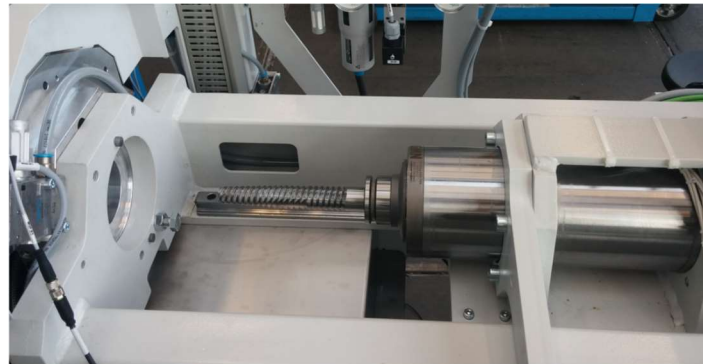
Abb. 5: Gehäuse mit der Spindellagerung sowie die Mischschnecke der Einspritzeinheit
