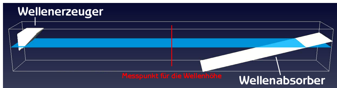
Abb. 5.1.1: Aufbau des implementierten Numerischen Wellenbeckens. Als Beispiel ist hier ein Keil Wellenerzeuger dargestellt. Das Becken ist 250\text{ cm} \times 35\text{ cm} \times 30\text{ cm} groß und an allen Gebietsrändern wird eine Rutschrandbedingung festgelegt. Entlang der roten Linie wird die Wellenhöhe gemessen (eigene Abbildung).
