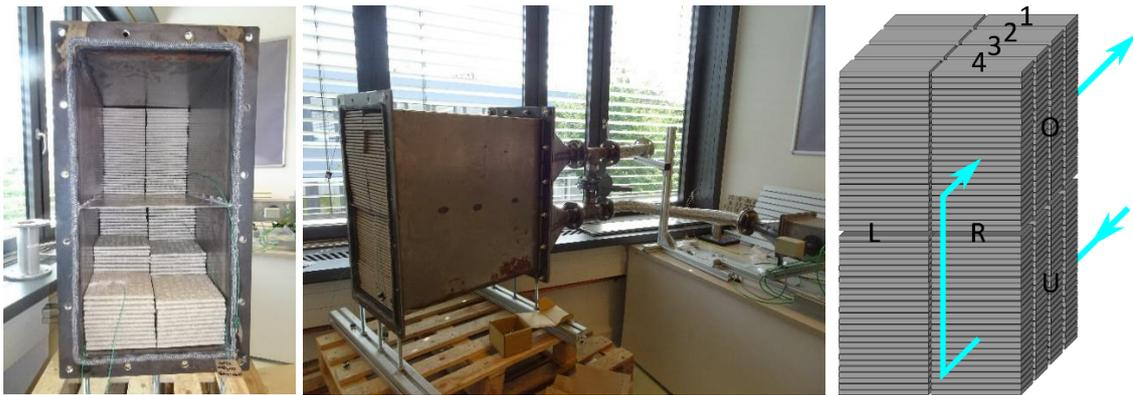
Abb. 1-57 Links: teilbestückter LuVo-Speicher, mitte: an den Heißluftkanal-Versuchsstand gekoppelter und voll bestückter Speicher, rechts: Bezeichnung der Fliesenstapel im Speicher und Darstellung des Strömungsweges
