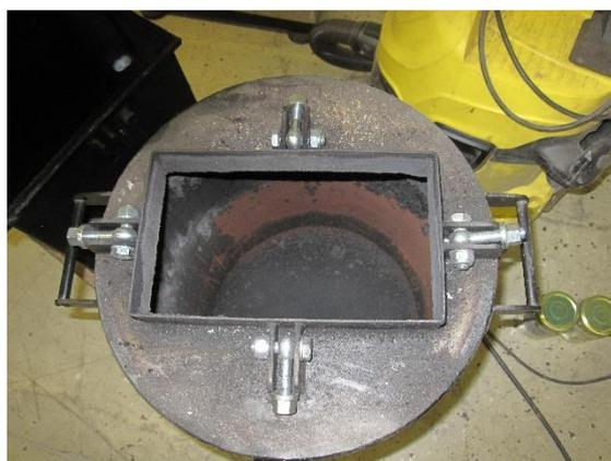
Abb. 1-33 Nach der MF deinstallierter Filterstaubbehälter zur Abwägung und Probenahme des Filterstaubes
