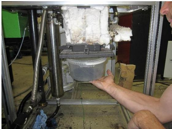
*Abb. 1-35 Nach der MF Probenahme der Rostasche bei laufendem Rost*
