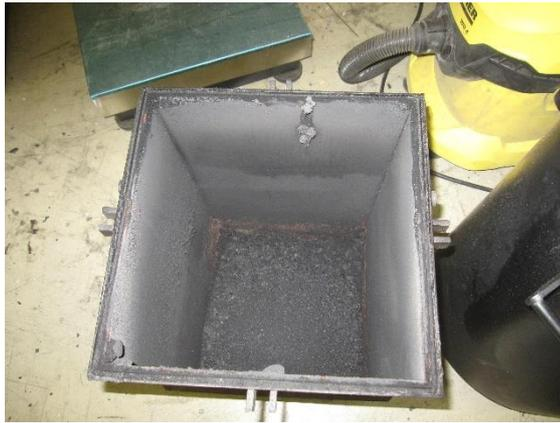
*Abb. 1-34 Nach der MF deinstallierter Rostaschesammelbehälter zur Abwägung der Rostasche*
