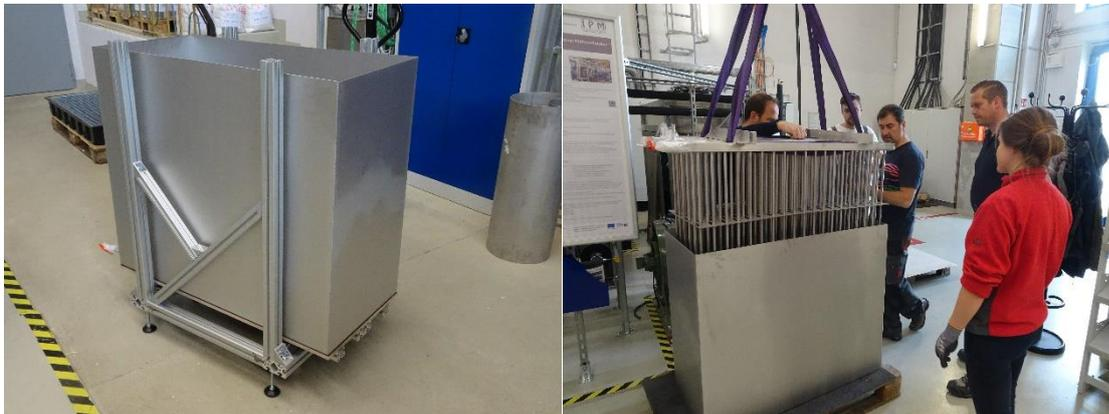
Abb. 1-46 links: Speicherbehälter auf Ständerwerk ;rechts: Kollegin und Kollegen mit viel Interesse und Unterstützung beim Speicheraufbau
