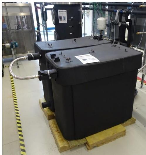
Abb. 1-50 Isolierte Speicherdemonstratoren in Kaskadenschaltung
