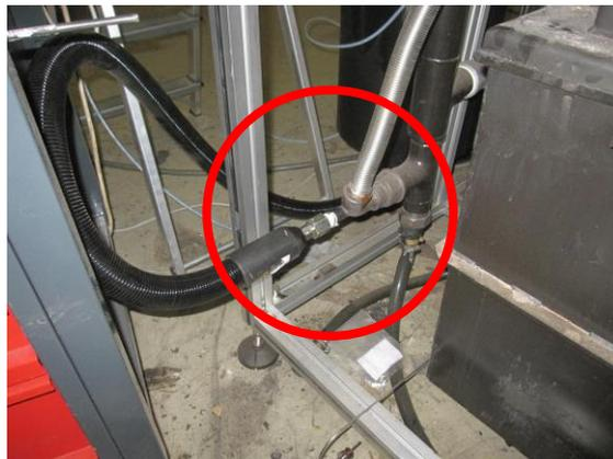
Abb. 1-32 Darstellung der Messstelle zur Erfassung des Produktgas-Wassergehaltes
