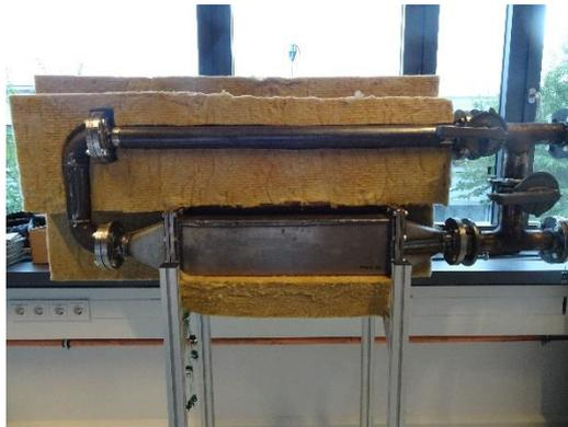
Abb. 1-66 LuVo-Speicher 2 mit halber Isolierung und Bypass-Verrohrung am Heißluftkanal
