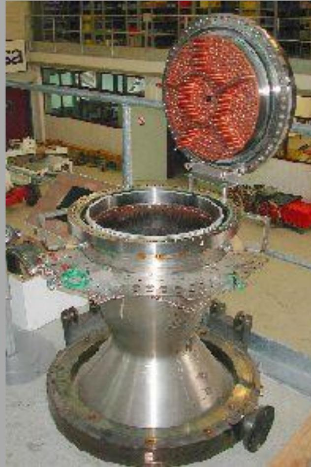
Die Brennkammer besitzt die Form einer Lavaldüse. Aufgeklappt, schaut man auf den Injektorkopf mit den Einspritzdüsen für flüssigen Sauerstoff und Wasserstoff.
