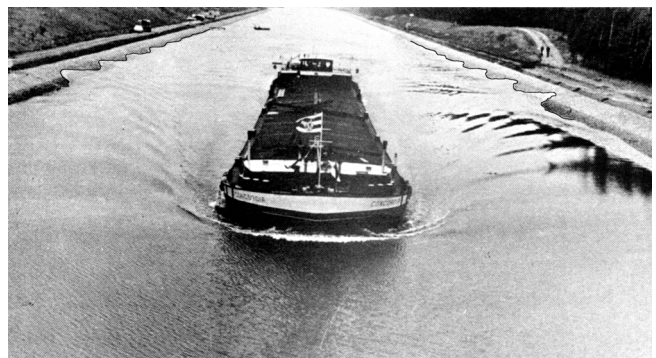
Bild 5.22 Fahrt des MS Concordia am Main-Donau-Kanal (Kriegenbrunner Messungen) im Bereich der kritischen Schiffsgeschwindigkeit ( v_s = 12 \text{ km/h} ) /Schäle, Mollus 1971/
